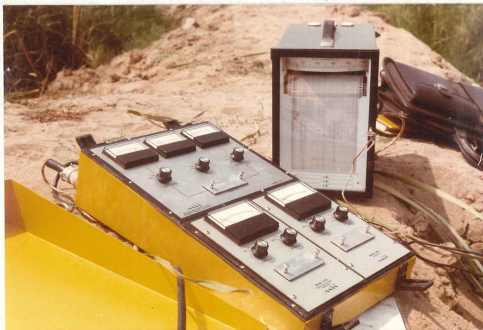
Εικ. 7. Αυτόματη παρακολούθηση της θερμοκρασίας, D.O., pH και αγωγιμότητας του νερού της δεξαμενής με κατάλληλο καταγραφικό όργανο (MARTEK):
