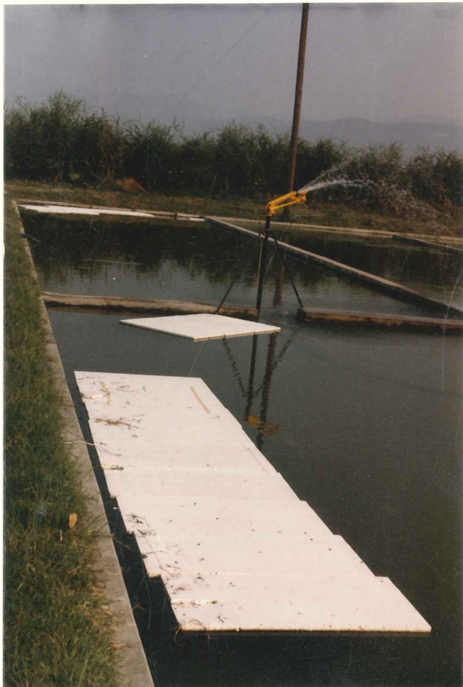
Εικ. 12. Πλάκες πολυαιθυλενίου που χρησιμοποιήθηκαν στις δεξαμενές πειραματισμού για τον περιορισμό της φωτοσυνθετικής δραστηριότητας των χλωροφυκών.
